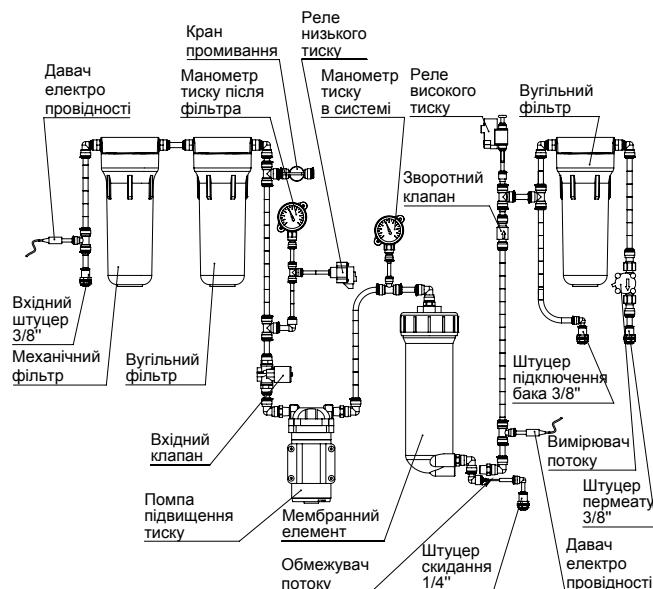
Рисунок 4. Схема системи ROust 1500 EC (МО-1500 EC)
