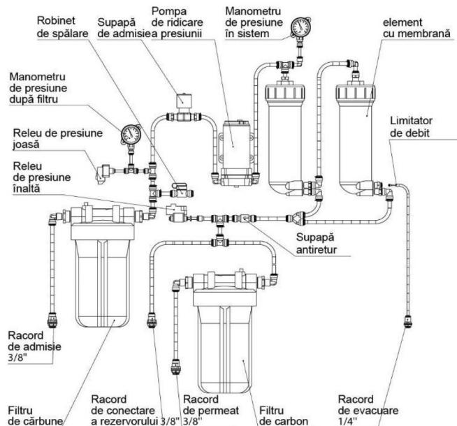
Figura 7. Schema sistemului RObust 3000
