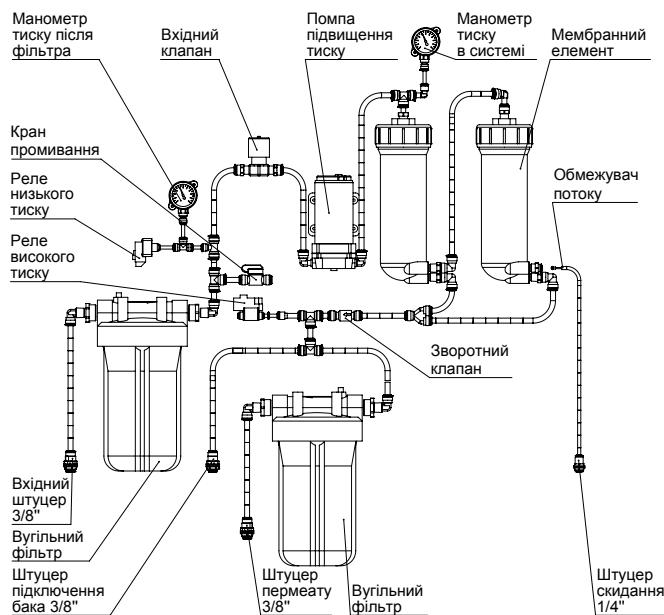
Рисунок 7. Схема системи ROust 3000 (MO-3000)
