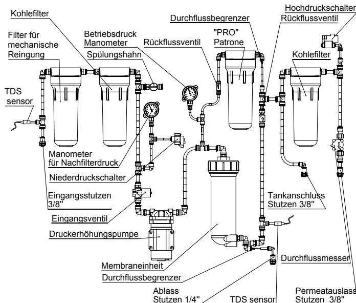
Abbildung 6. Schema des Systems RObust PRO EC
