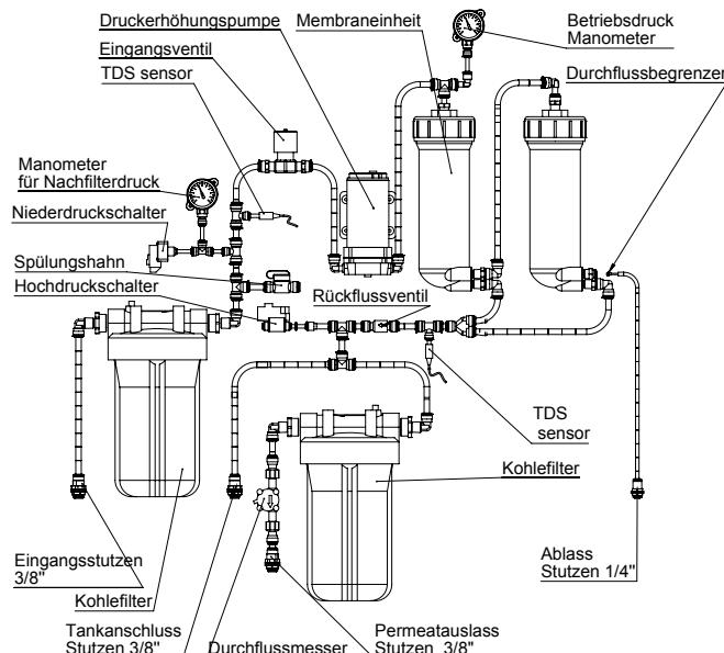
Abbildung 8. Schema des Systems ROBUST 3000 EC
