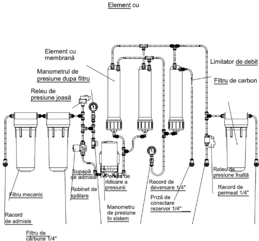
Figura 2. Schema sistemului RObust 1000
