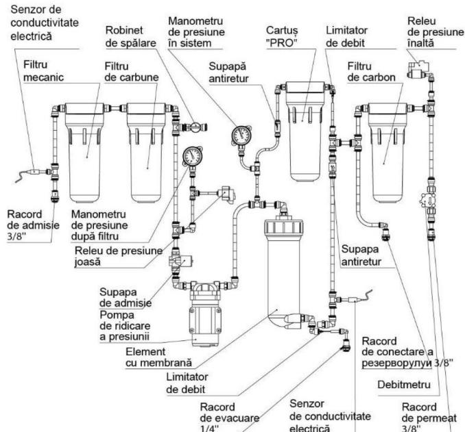
Figura 6. Schema sistemului ROBUST PRO EC
