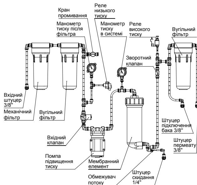
Рисунок 3. Схема системи ROust 1500 (МО-1500)
