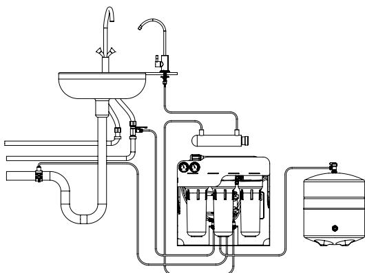
**Очищена вода.** Трубка від виходу "Очищена вода" до УФ-лампи.
