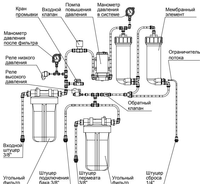
Рисунок 7. Схема системы ROust 3000
