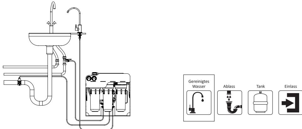
**Gereinigtes Wasser.** Rohr vom Auslass gereinigtes Wasser zum Wasserhahn für gereinigtes Wasser.
