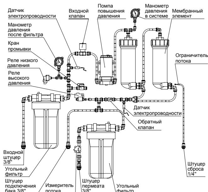
Рисунок 8. Схема системы ROust 3000 EC
