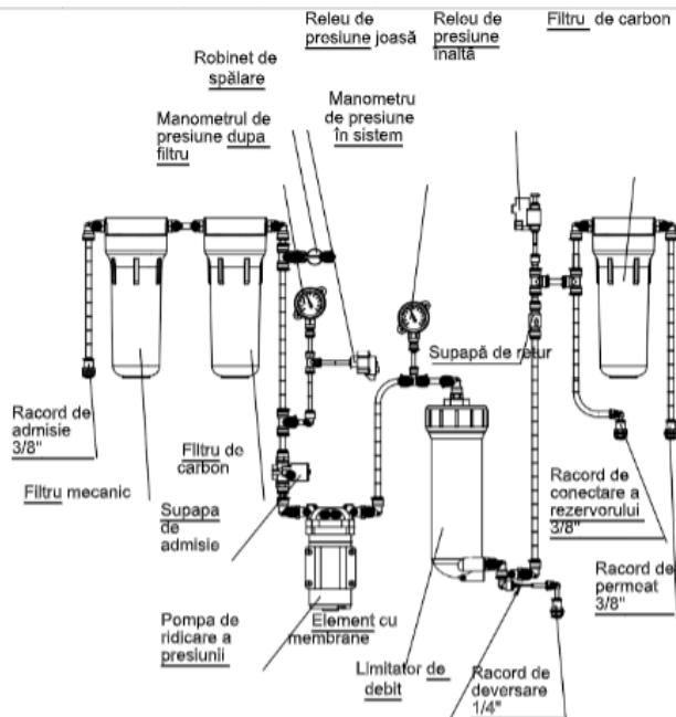
Figura 3. Schema sistemului RObust 1500
