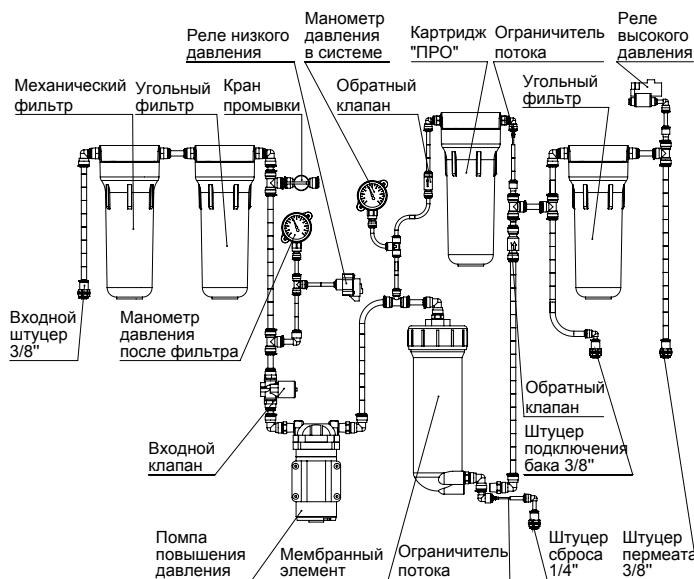
Рисунок 5. Схема системы ROust PRO
