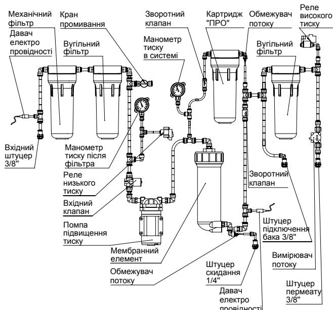
Рисунок 6. Схема системи ROust PRO EC (MO-1500)
