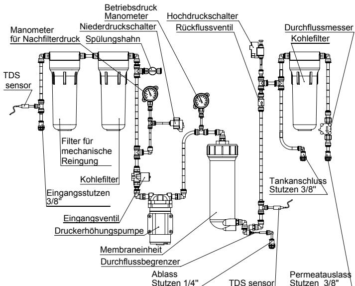
Abbildung 4. Schema des Systems ROBUST 1500 EC
