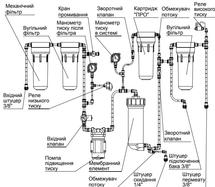
Рисунок 5. Схема системи ROust PRO (MO-1500)
