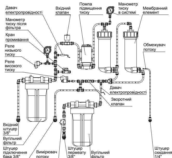
Рисунок 8. Схема системи ROust 3000 EC (MO-3000)
