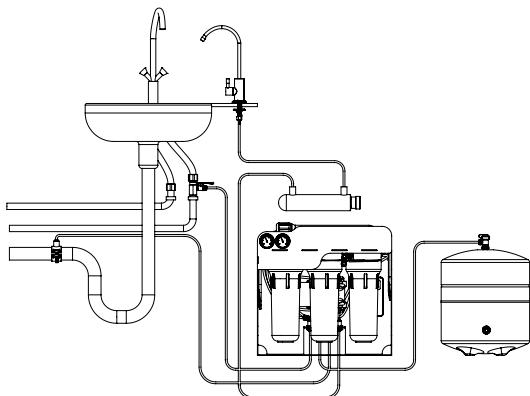
**Очищенная вода.** Трубка от выхода "Очищенная вода" к УФ–лампе.
