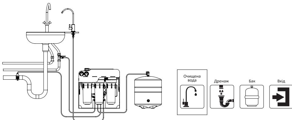
Очищена вода. Трубка від виходу "Очищена вода" до крану очищеної води.
