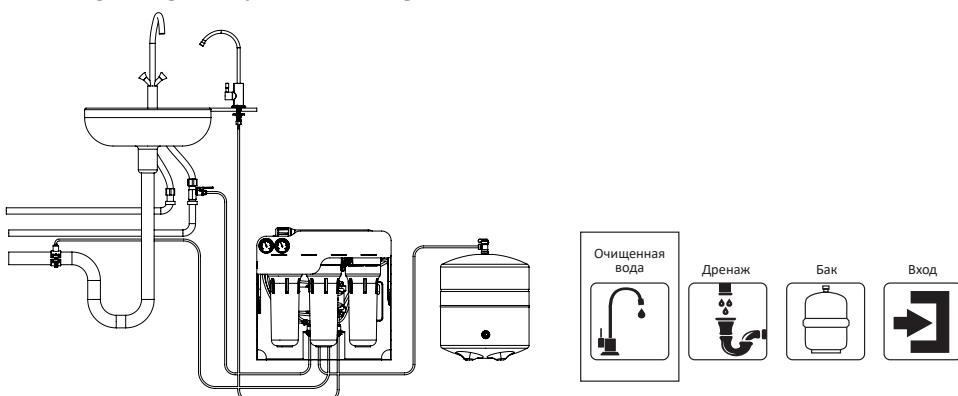
**Очищенная вода.** Трубка от выхода "Очищенная вода" к крану очищенной воды.
